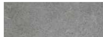
Поверхности, затертые при помощи стальных инструментов (гладкие) STG 24, STG 36 или STG 46 + затирочные лезвия
